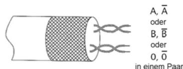
Der Schirm muss beidseitig auf dem gesamten Kabelumfang mit Masse verbunden werden. Wenn möglich, dann verbinden sie die 0V der Versorgungsspannung mit „Erde“ auf der Steuerungsseite. Das Gebergehäuse muss über den Flansch auch mit „Erde“ verbunden werden. Deshalb darf die Geberbefestigung weder gestrichen noch beschichtet sein. Die 0V sollte nach der „Sterntechnik“ verteilt und verbunden werden.
