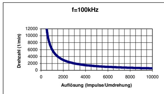
Die meisten Steuerungen/Zähler sind mit Rechtecksignal-Eingängen ausgestattet, die eine Multiplikation der Scheibenauflösung mit 2 oder 4 ermöglichen. 10 000 Messschritte können aus den A- und B-Signalen des Drehgebers, der 2500 Schritte pro Umdrehung besitzt, erzeugt werden.
