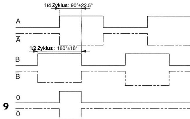
Die 90° elektrische Phasenverschiebung zwischen A und B Signal bestimmt die Drehrichtung:
