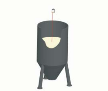
Niveaumessung in Silos
