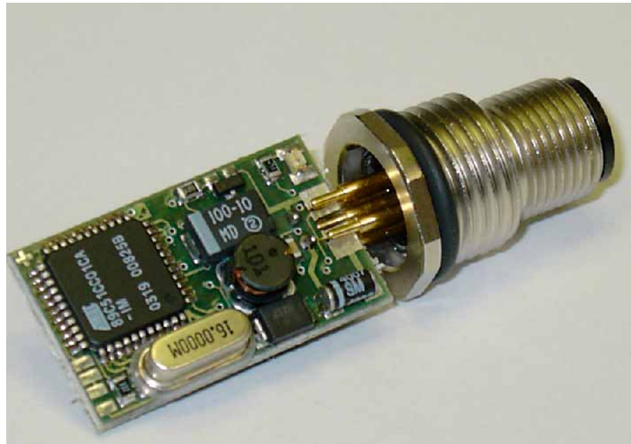
Abb. 7: Platine mit M12-Steckverbinder
